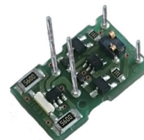
端子挿入から部品実装
